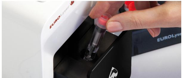
02 Déposez l'échantillon directement dans le tube de réactif et insérez ce dernier dans le tiroir de l'analyseur.
